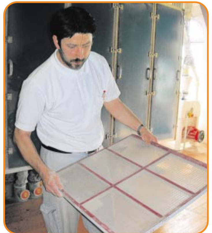
DAS SIEB einer Maschine ist kaputt. Der Müller tauscht es entweder aus oder repariert das defekte Teil.
