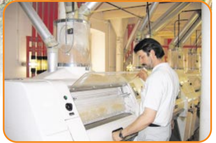
BEIM KONTROLLGANG durch sämtliche Stockwerke der Mühle prüft der Obermüller die Mahlwerke, die sogenannten „Walzenstühle“ auf dem Walzenboden.
